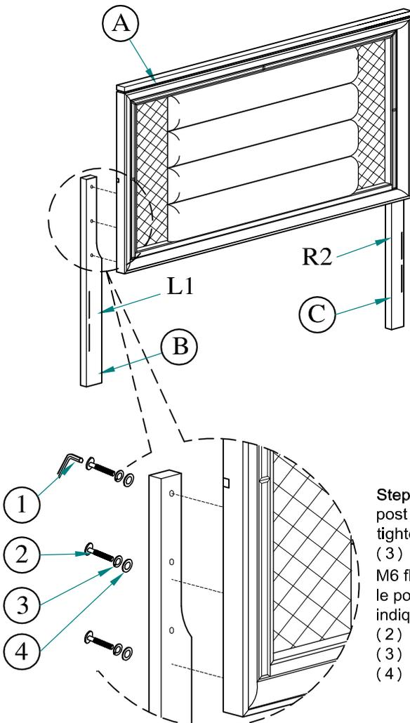
**Step 1:** Attach the (B) extension post as shown in the drawing and tighten with (2) JCBC 35mm, (3) M6 spring washer & (4) M6 flat washer. / **Étape 1:** Attachez le poste d'extension (B) comme indiqué dans le dessin et serrez avec (2) JCBC 35mm des boulons, (3) M6 rondelle d'arrêt et (4) M6 rondelle plate.
