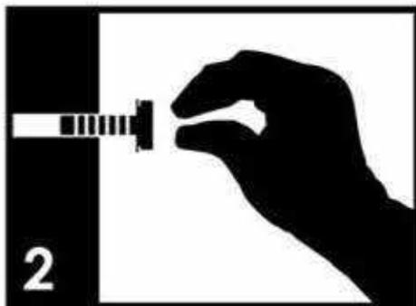
2 Positionnez correctement chacune des pièces et insérez les vis dans leurs orifices respectifs. Puis serrez à la main seulement jusqu'à 70 %. Resserment complète avec les outils viendrez à une étape ultérieure.
