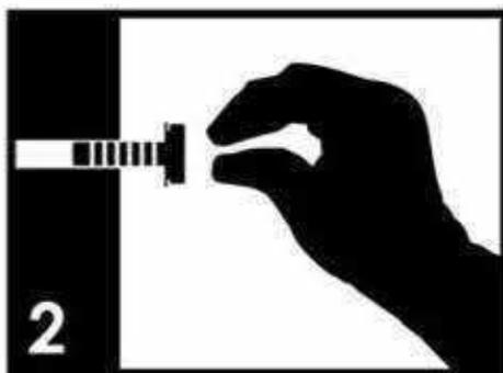
2 Positionnez correctement chacune des pièces et insérez les vis dans leurs orifices respectifs. Puis serrez à la main seulement jusqu'à 70 %. Resserrement complète avec les outils viendrez à une étape ultérieure.
